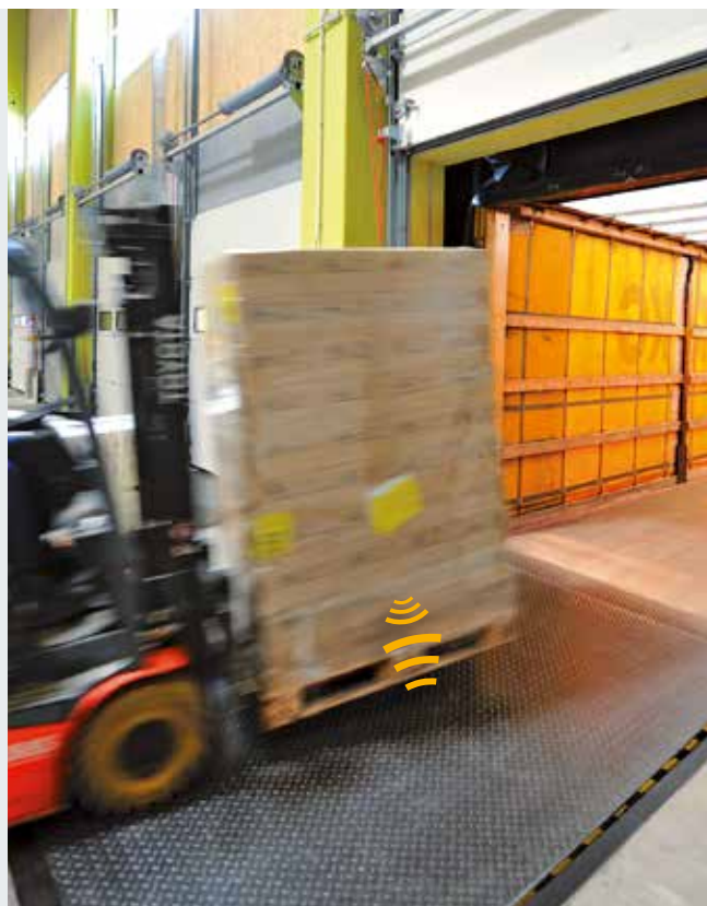
Automatyczne ewidencjonowanie przepływu towarów podczas przejeżdżania przez rampę przeładunkową.
