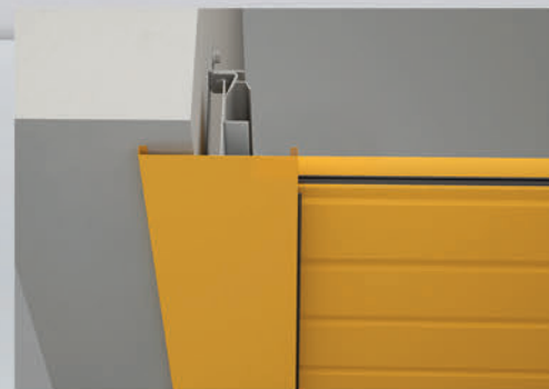
Montaż w otworze - maskownica przed otworem
